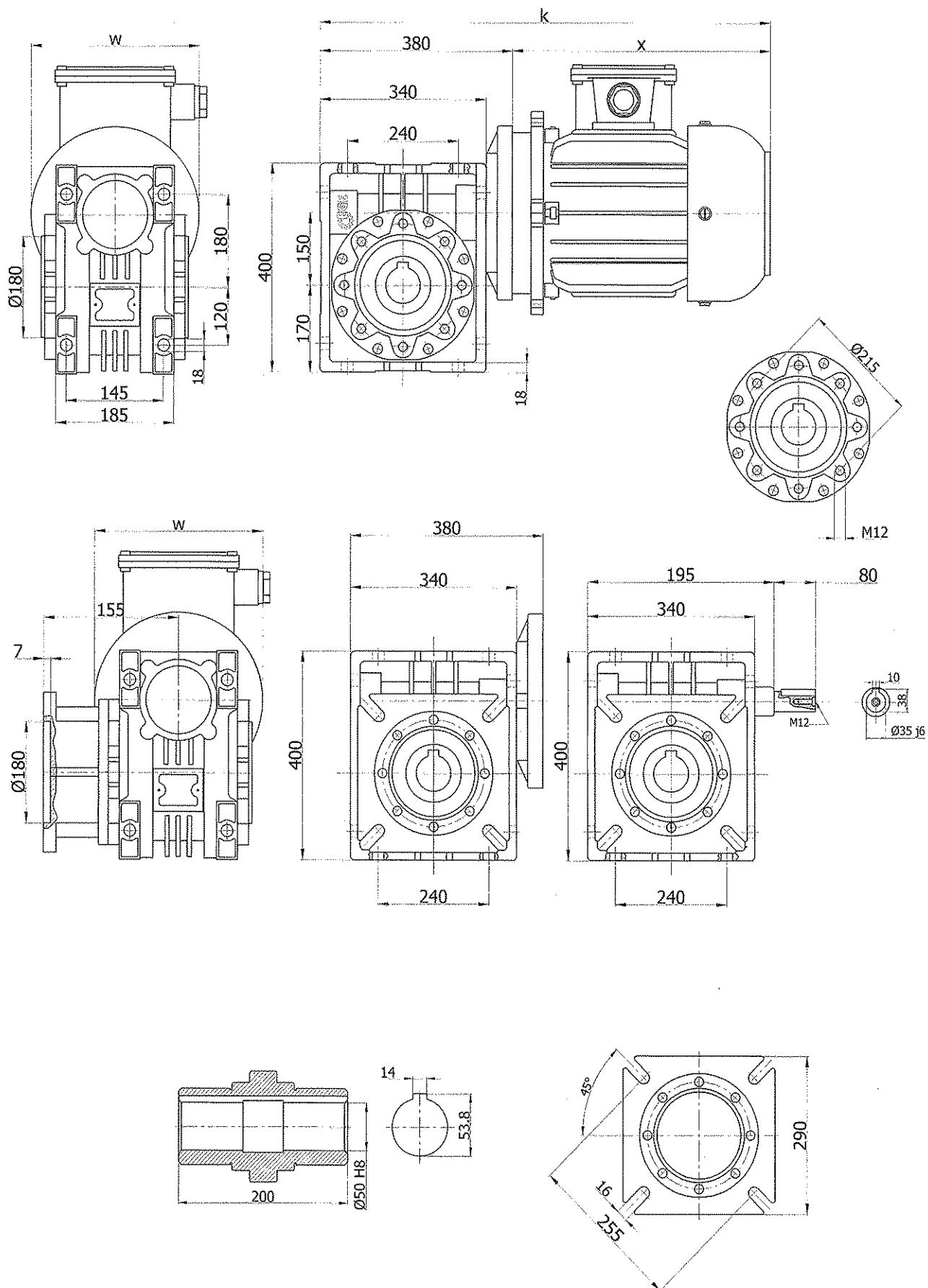
**Not:** "K", "x", "w" ölçülerini motor boyutlarına bağlı olarak değişmektedir. Bu ölçüler için "MOTOR BOYUTLARI SAYFASI'na" bakınız.
