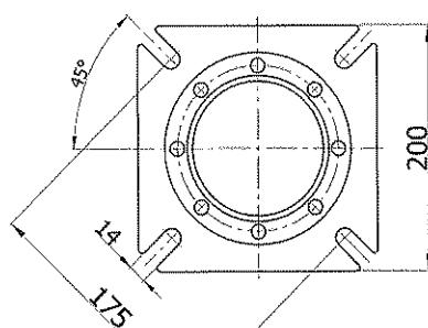
Not: "K", "x", "w" ölçüler motor boyutlarına bağlı olarak değişmektedir. Bu ölçüler için "MOTOR BOYUTLARI SAYFASI'na" bakınız.
